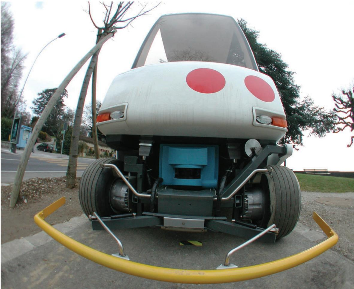
*Face avant d'une capsule avec les capteurs de sécurité*
